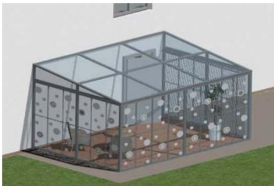
Solution de secours posée après coup : apposition d'autocollants sur les surfaces vitrées. Veillez à appliquer les supports à l'extérieur du jardin d'hiver (avec une qualité adaptée), au minimum sur les côtés latéraux de la construction. Le choix des motifs et de la couleur est libre. Dans l'idéal, il ne reste aucune surface libre ayant une taille plus grande que la paume d'une main.
